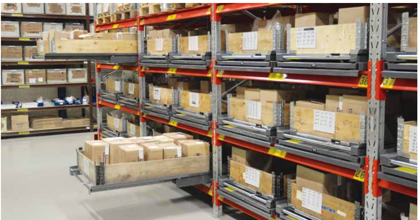
Con estantes telescópicos se consigue un almacenaje más compacto y un picking más fácil.
